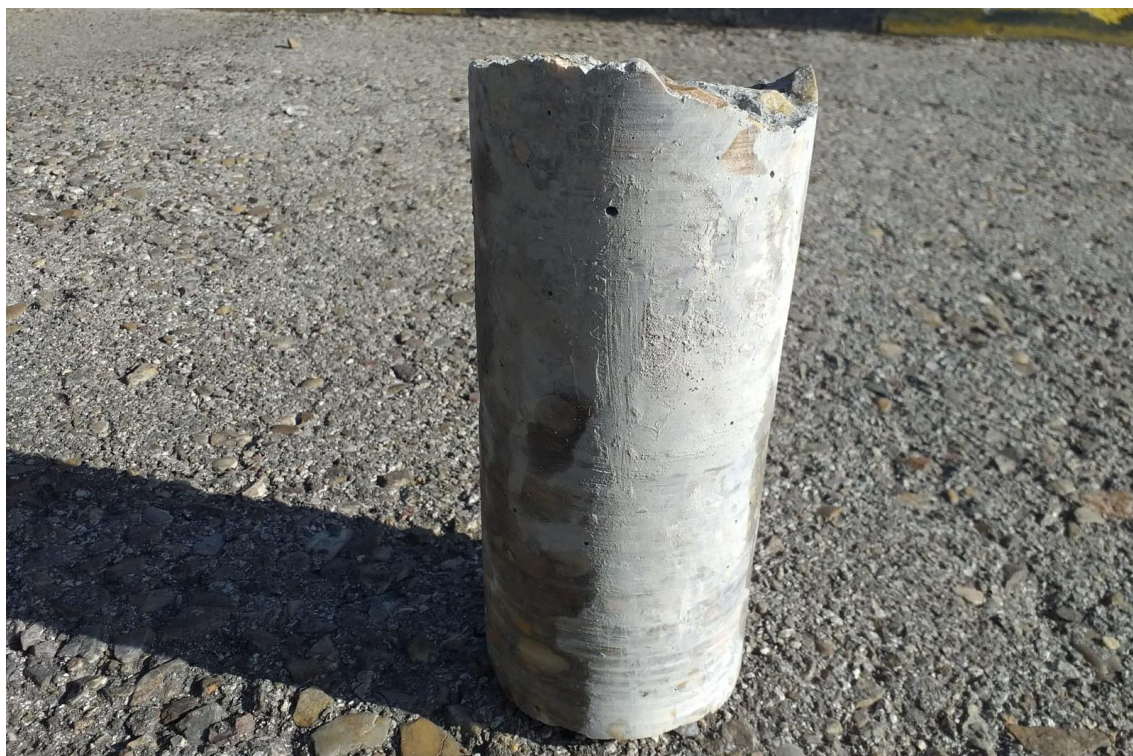
Figura 2-60 Testigo de investigación árido-álcali.
