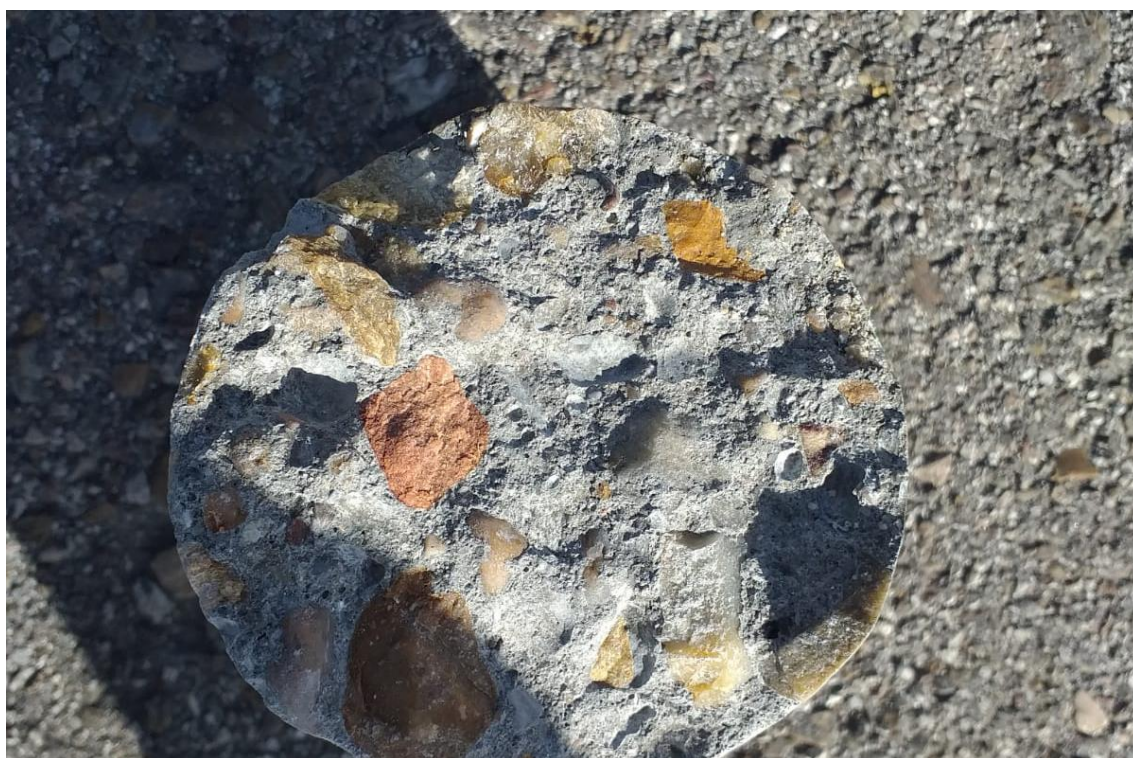
Figura 2-61 Sección testigo de investigación árido-álcali.
